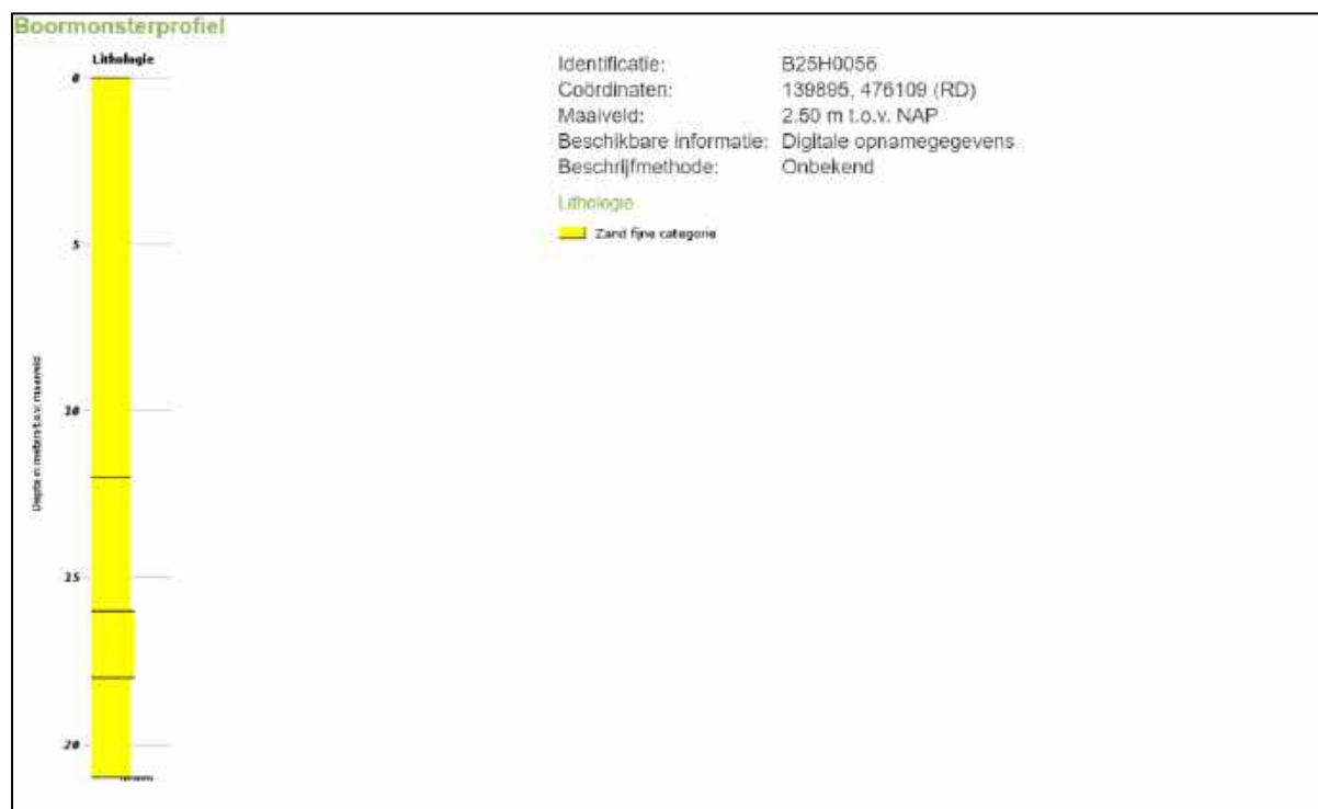
Figuur 2. Bodemopbouw boormonster (B25H0056)
