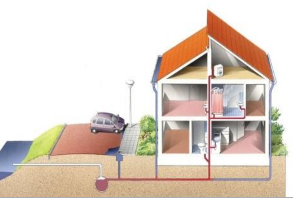
Bestaande situatie: één rioolbuis (gemengde riolering)
