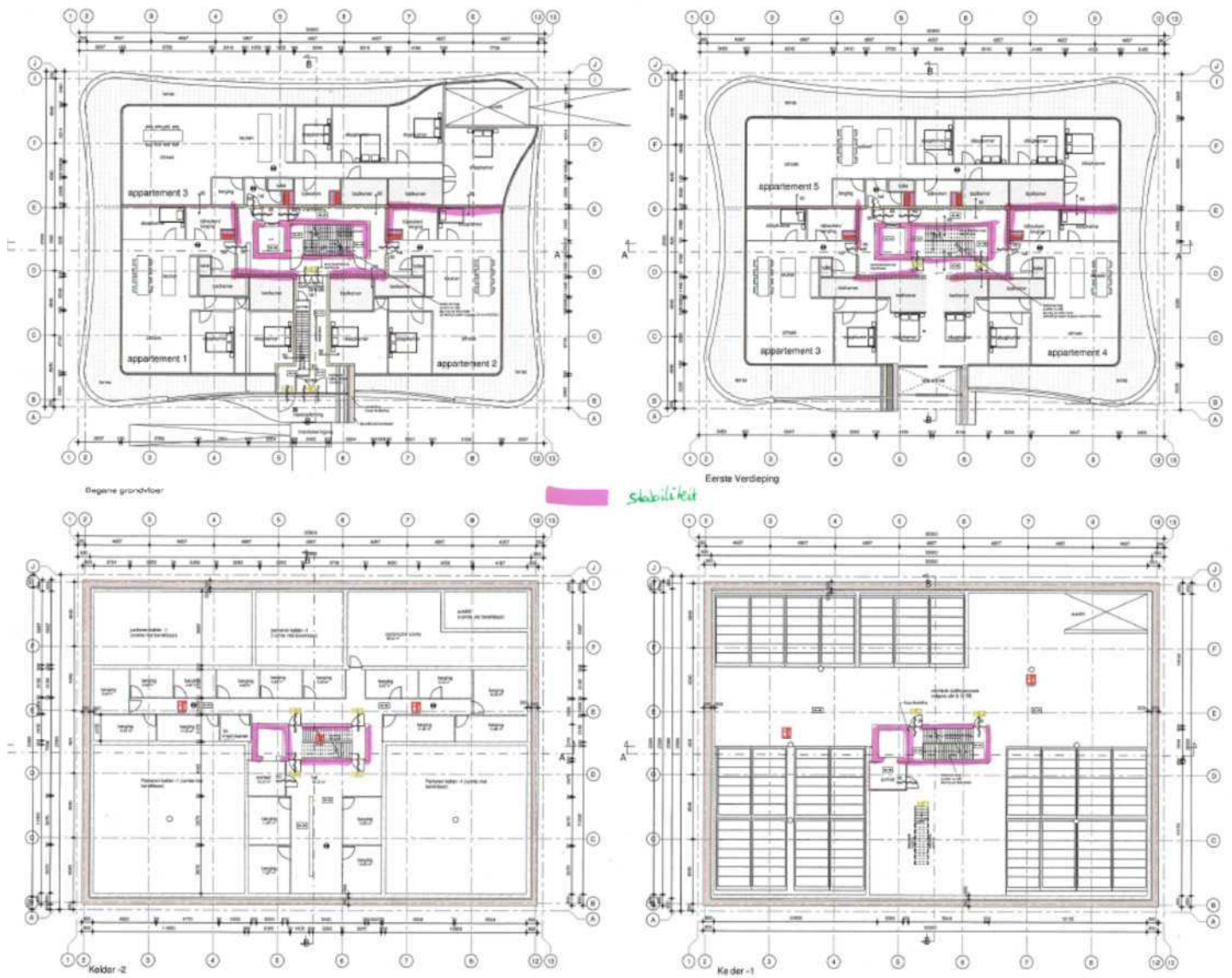
Figuur 5: plattegrond met stabiliteitswanden
