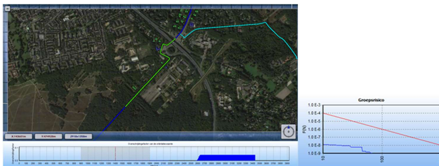
Figuur 22: De kilometer leiding op het voormalig defensie terrein Crailo en de fN-curve voor deze kilometer leiding in de huidige situatie. Zie Figuur 20 voor de legenda.
