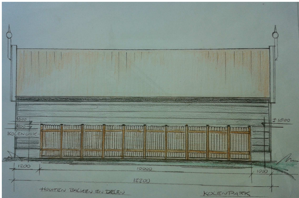
Detailtekening kolenpark (zijaanzicht)
