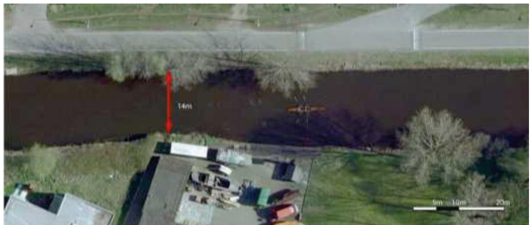
Afbeelding 15: Tweede knelpunt: de oever is hier verbreed met een beschoeiing
