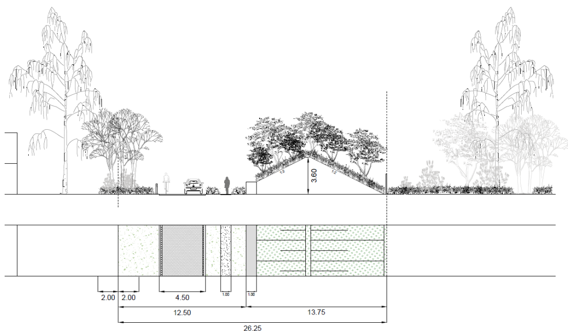
Figuur 3.1 Profiel van een deel van de ecowal
