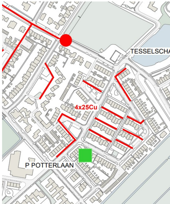
Figuur 2: Liander elektra, te vervangen 25Cu bekabeling
