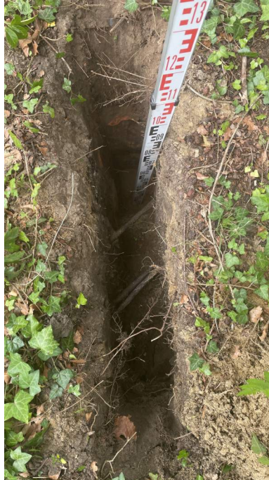
Afbeelding 15: Bodemprofiel met intensieve fijne beworteling. Op een diepte van 60 cm beneden maaiveld zijn drie metalen kabels te zien met een dikte van 1,5 cm
