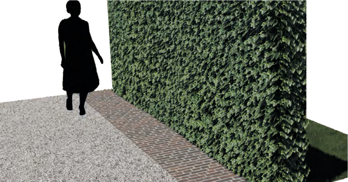
wandelpad 50-70mm halfverharding schots granietgruis 0-5mm 150mm menggranulaat 4/31,5 opsluiting met dubbele strek
