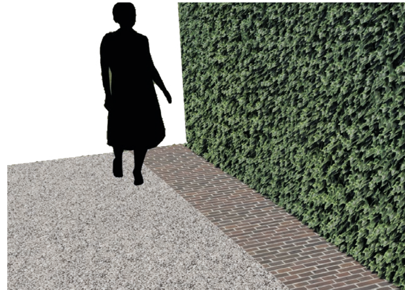
figuur 37: impressie wandelpad , 50-70mm halfverharding, schots granietgruis 0-5mm, 150mm menggranulaat, 4/31,5 opsluiting met dubbele strek
