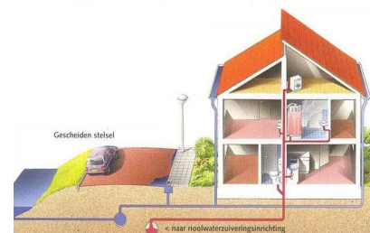
Figuur 1 Gemengde riolering (boven) en gescheiden riolering (onder). Bron: Paul Maas, Tilburg/Stichting RIONED.
