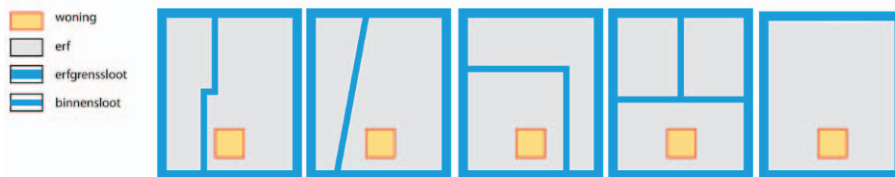
Figuur 6. Principeschetsen van sloten op het erf die de erfdelen van elkaar scheiden.
