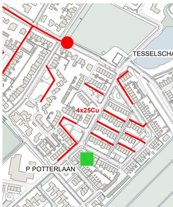
Figuur 2: Liander elektra, te vervangen 25Cu bekabeling
