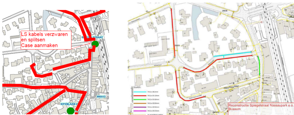
Figuur 7 en 8: Liander: te verzwaren laagspanningskabels (links) en te vervangen gasleidingen (rechts)
