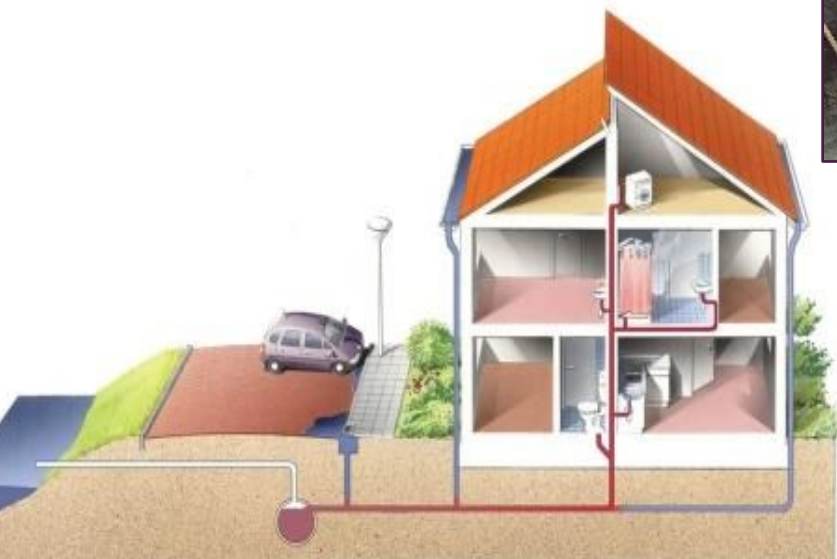
Bestaande situatie: één rioolbuis (gemengde riolering)
