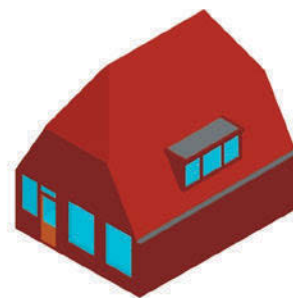
Dakkapel op het hoofddakvlak plaatsen (en dus niet op een wolfseind)
