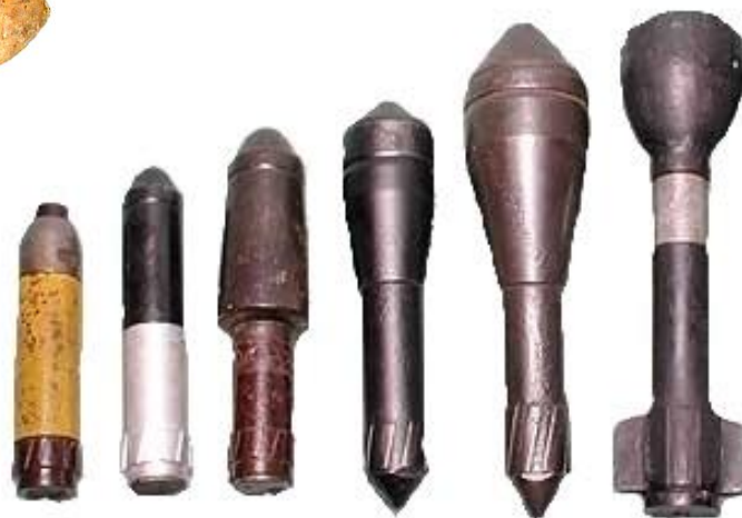
Diverse geweergranaten (onderkant circa Ø 30mm)
