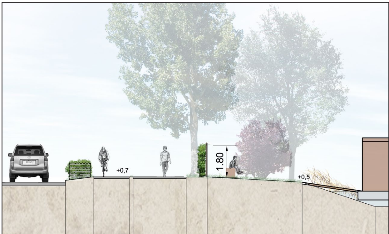
principedoorsnede breed - dicht met private tuin inzoom afscheiding dmv groene constructie 1,80meter hoog
